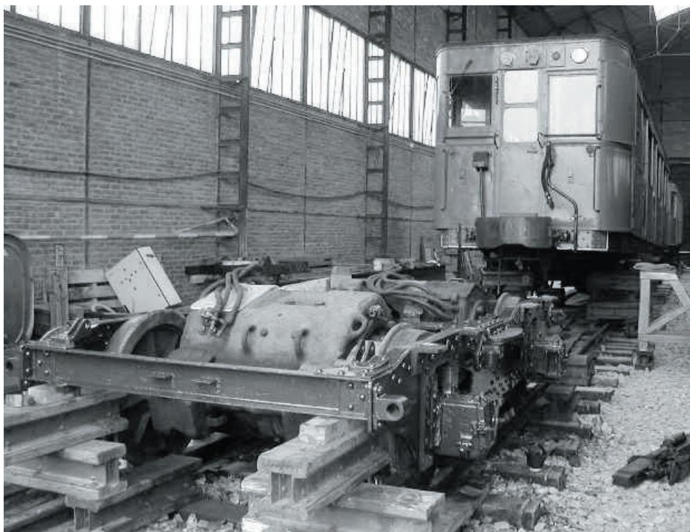
Vue détaillée des travaux engagés sur le bogie avant de la M. 340. Les quatre ressorts de suspension ont été déposés et seront remplacés par des neufs. La timonerie a été démontée, chaque pièce a été réparée ou remplacée. Dans la mesure des stocks disponibles, les pièces d'usure sont remplacées par des neufs. Le bogie a enfin été gratté et décapé, puis repeint. Vue prise le 12 mars 2004. (photo Julian Pepinster)
