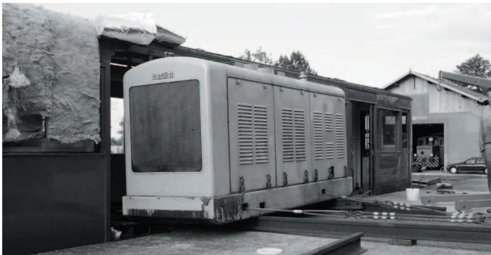
Dépose de l'ancien groupe Berliet... un gros bébé pesant 5 tonnes ! - le « manteau » de laine de verre sur la caisse sert à la maintenir à température convenable pour les travaux de peinture intérieure. (photo Dominique Craquelin)
