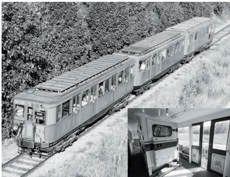
Depuis les 20 et 21 septembre 2008 circule de nouveau la formation verte, tractée par la M. 340, désormais remotorisée, fruit du travail d'une année. Le nouveau groupe électrogène est moins bruyant, moins lourd et plus puissant. L'intérieur de la voiture a été entièrement repeint. (photos Martin Loyer)
