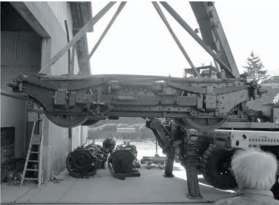
Départ d'un bogie ancien, les moteurs qui équiperont le bogie "neuf" sont visibles au fond. (photo Dominique Craquelin)
