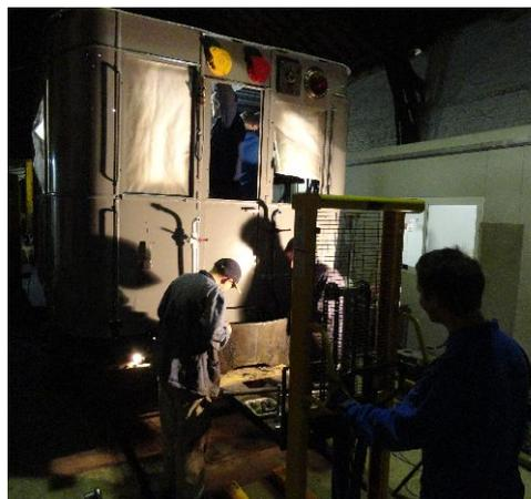
*Révision individuelle des équipements (ici, des contacteurs), dépose des équipements en loge avant et décapage mécanique, peinture intérieure. (J. Pepinster)*
