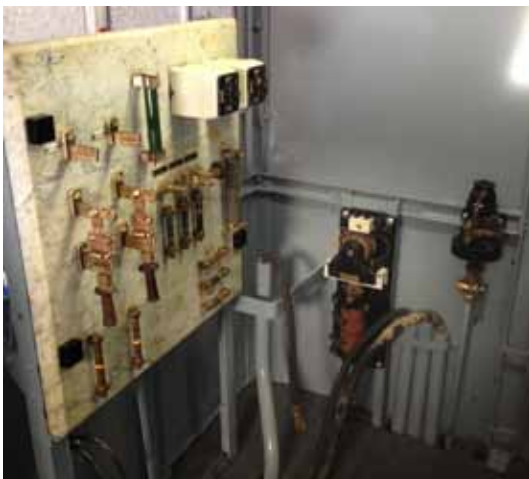
À gauche, les composants d'ores et déjà remontés dans la loge avant du T91 ; à droite, la tôle percée qu'il nous va falloir remplacer sur la M340. (J. Pepinster).
