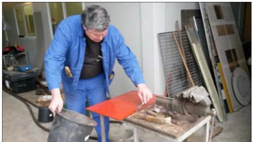
Le décapage chimique des tôles est une opération de patience, facilitée, pour les portes, par la dépose de ces tôles. Sur la caisse de la voiture, il faut répartir le produit sur une surface verticale. L'emploi d'un décapant en gel facilite l'opération mais produit une « boue » de peinture ramollie particulièrement salissante qui nécessite de protéger soigneusement l'espace de travail. (A. Marcinkiewicz)
