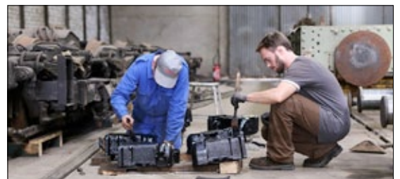
Décapage des suspensions de l'un des bogies du F2020 (J. Pepinster) ; peinture des boîtes d'essieux. (B. Bessis)
