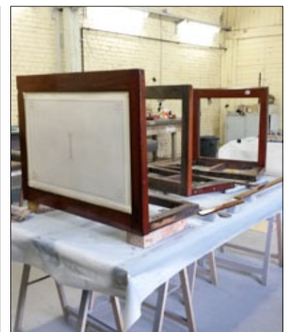
Outre leur aspect, les structures des banquettes peuvent nécessiter des réparations plus ou moins conséquentes : recollages, remplacement d'une ou plusieurs lattes, reconstitution de pièces structurales ... même si elles ne subiront plus l'assaut des heures de pointe parisiennes, elles doivent être solides et sûres pour leurs futurs visiteurs et voyageurs ! (A. Marcinkiewicz)
