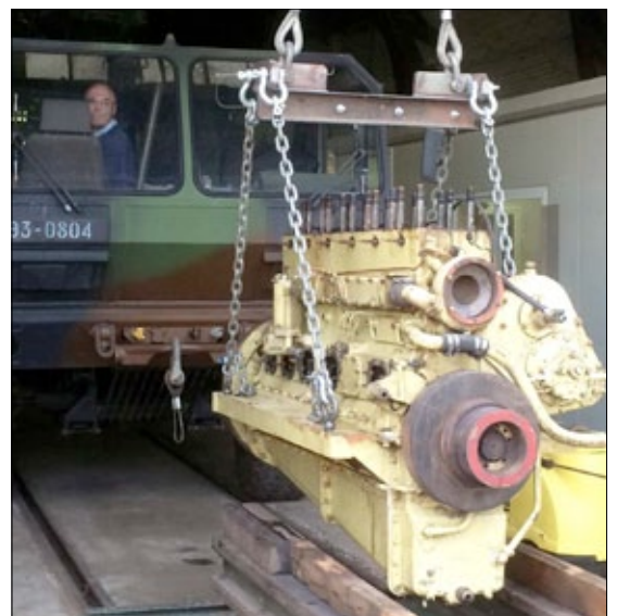
Une délicate manœuvre menée à bien : dépose du moteur du Diplodocus au sein d'un espace très restreint, installation de l'appareil dans l'atelier en vue de sa révision. (J. Pepinster)
