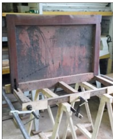
Outre leur aspect, les structures des banquettes peuvent nécessiter des réparations plus ou moins conséquentes : recollages, remplacement d'une ou plusieurs lattes, reconstitution de pièces structurales ... même si elles ne subiront plus l'assaut des heures de pointe parisiennes, elles doivent être solides et sûres pour leurs futurs visiteurs et voyageurs ! (A. Marcinkiewicz)
