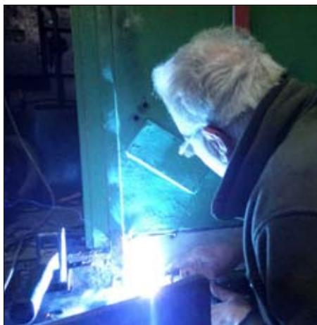
*Soudure au MIG d'une tôle de réparation à l'avant droit de la M. 340, cette opération était indispensable avant de repeindre l'avant de la motrice. (J. Pepinster)*
