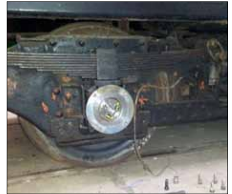
Adaptation de la commande du graisseur sur une boîte à rouleaux de la Ab.284 (A. Marcinkiewicz)
