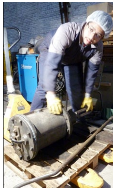
Le cylindre de frein de la Bb.546 prêt à être reposé.. (A. Prodanovic)
