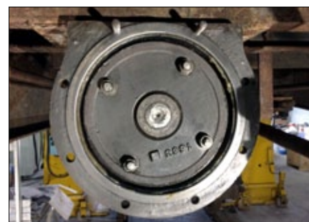
Le cylindre de frein de la Ab.487 prêt à refonctionner. (J. Pepinster)
