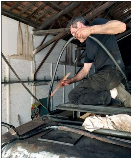
Recâblage de la Bb 782. L'image ne traduit pas la forte résistance à l'avancement. Le câble doit être graissé, poussé et tiré pour ressortir à l'autre bout - objectif atteint ! (J. Pepinster)
