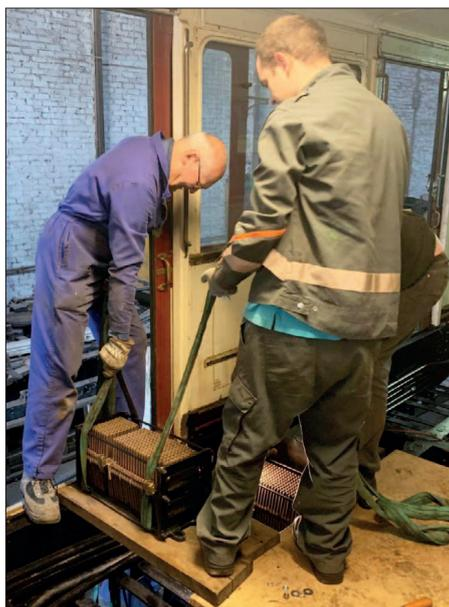
*Repose précautionneuse des bancs de résistances, aussi lourds que fragiles. (B. Faudeux)*
