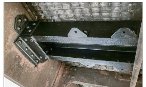
*Ci-dessus, le support du réservoir auxiliaire de la Bb.782 a été assaini.*
