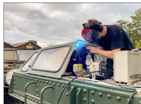
Une fois la géométrie corrigée, quatre bandes de soudure sont venues figer le résultat obtenu. Au second plan, l'élément de fond de cabine déposé à la grue pour pouvoir intervenir. (J. Pepinster)
