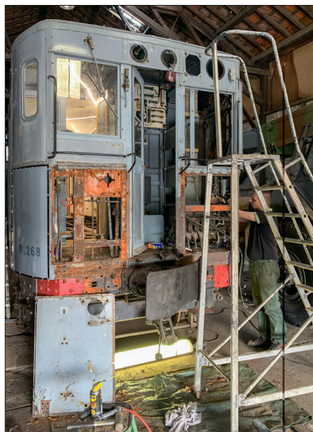
Ci-dessus, vue de la face après dépose des tôles corrodées le 3 septembre. (B. Faudeux)
