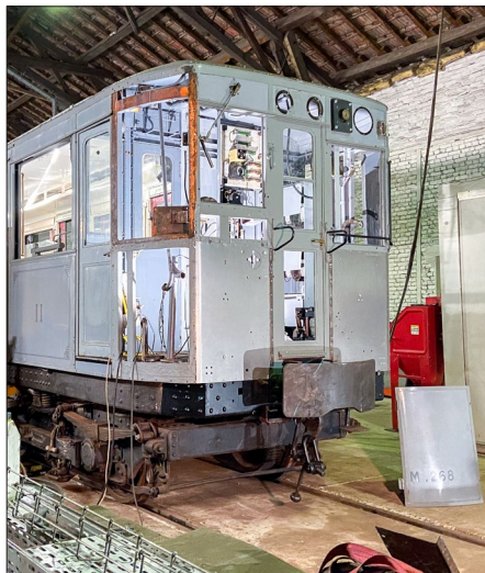
Les tôles brutes ont été ajustées et percées : elles vont repartir pour émaillage. (A. Marcinkiewicz)
