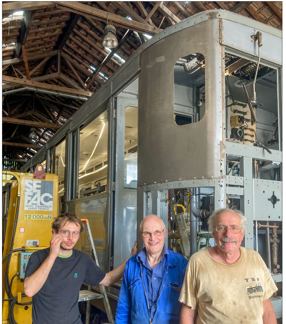
Heureux sommes-nous, le 18 juin, d'avoir reçu, enfin, la dernière tôle à émailler ! La voici présentée dans sa future position, les trous de fixation sont réalisés et tout est vérifié avant retour en Bretagne pour émaillage en même temps que les trois précédentes tôles. Il importe en effet qu'elles soient toutes traitées en même temps pour obtenir un résultat unifié. (J. Pepinster)
