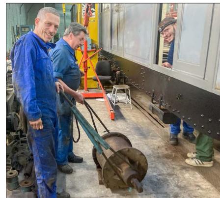
Le 2 octobre, dépose du cylindre de frein. (Ph. Maige)
