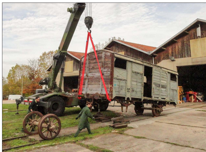
29 octobre : levage du wagon donneur et extraction de l'essieu. (D. Craquelin)
