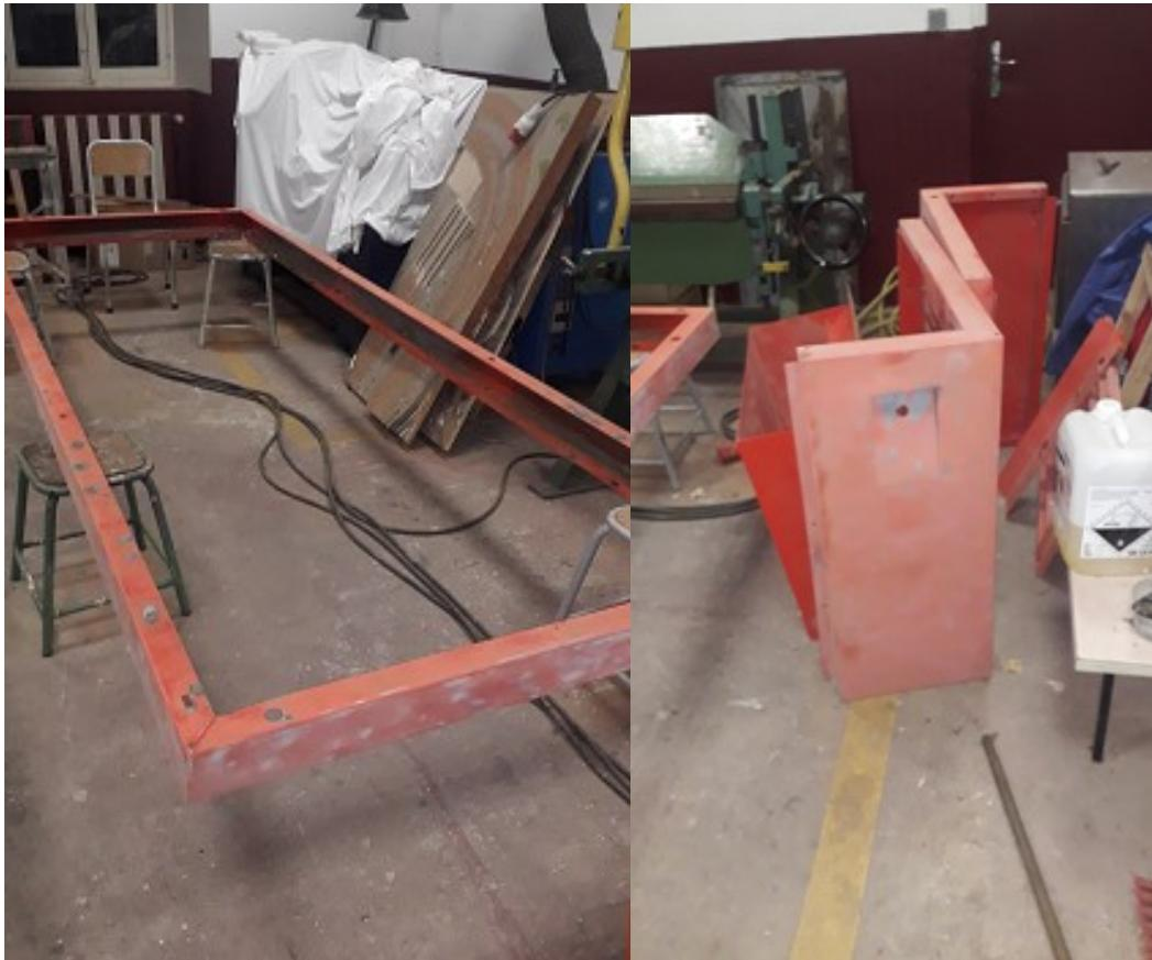
Soudure du dernier fer U (en remplacement des blocs de bois d'origine) de maintien de la tuyauterie sur la tôle AR G.
