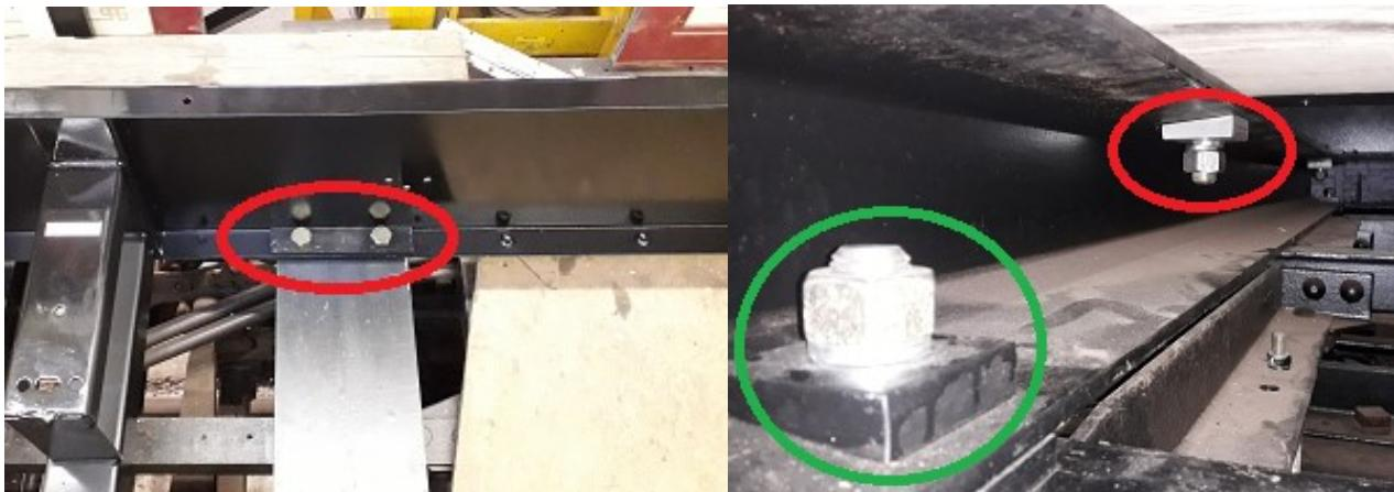
Traçage puis perçage châssis + équerres côté droit puis côté gauche
