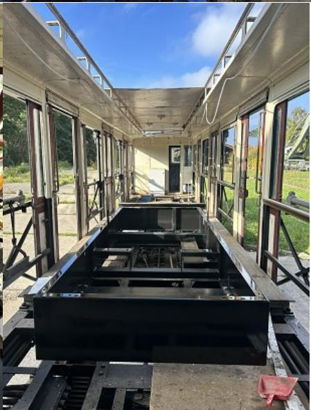
Des le support posé, fixation provisoire sur les 2 pistes pneu avec les cales anti-arrachement au-dessus et les cales biaises (rattrapage de la pente de la piste) en dessous (entourées en rouge) afin de tracer et percer l'équerre maintenant le rail avant sur le châssis de la voiture. L'équerre est maintenue par les cales biaise entourées en vert.
