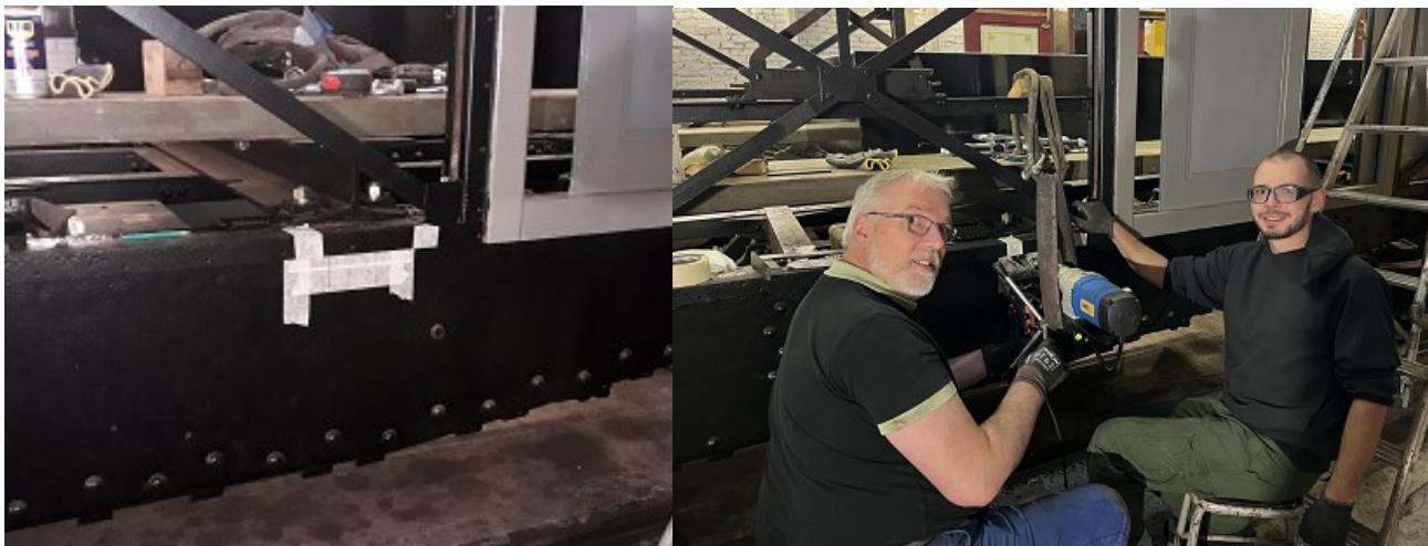
Une fois percées, les équerres et le support du groupe sont fixés définitivement puis le rhéostat et le dessus du piano sont soigneusement nettoyés pour éviter les problèmes d'isolement. Une réflexion à également été menée pour rendre étanche la partie inférieure du groupe et éviter que de potentielles fuites de fluides du groupe ne pollue la partie 600V (piano et rhéostat).
