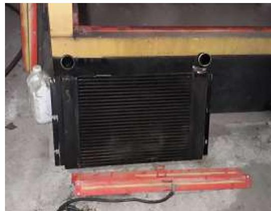
Les durites ayant été préalablement changées dans la semaine, repose des radiateurs et de leurs capotages puis réglages des tirants supérieurs pour l'ajustage des raccords du radiateur air-air.
