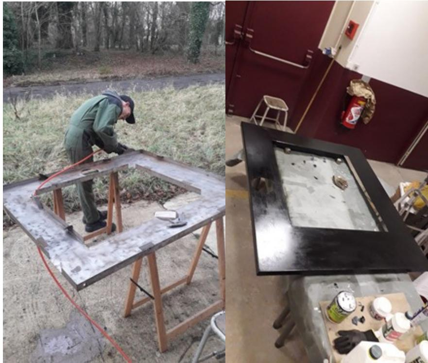
La tôle émaillée ARD a également été pré-positionnée afin de tracer les trous restant à percer sur la tôle (maintien des tuyaux d'alimentation de l'EV de porte) ainsi que dans le châssis (toute la rangée inférieure).
